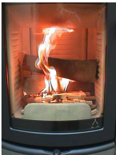
Fig. 5 : Fermeture du coulisseau d'entrée d'air primaire
