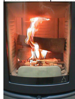
III. 3 : Chiusura presa dell'aria primaria
