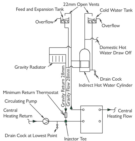
Fig. 8. Injector Tee
